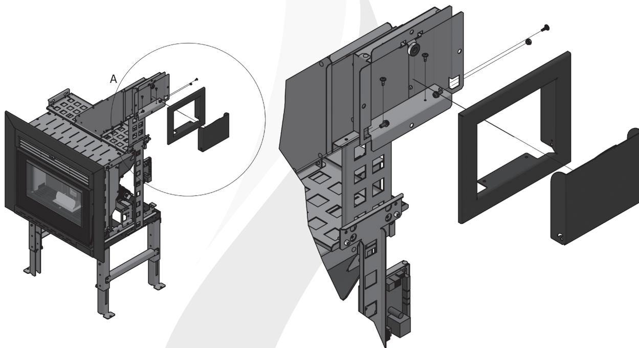
Una vez hemos desmontado la boca de llenado y el embellecedor procedemos a fijar la estructura del bajante en el revestimiento de nuestra instalación, tal y como se indica en la figura de abajo.
