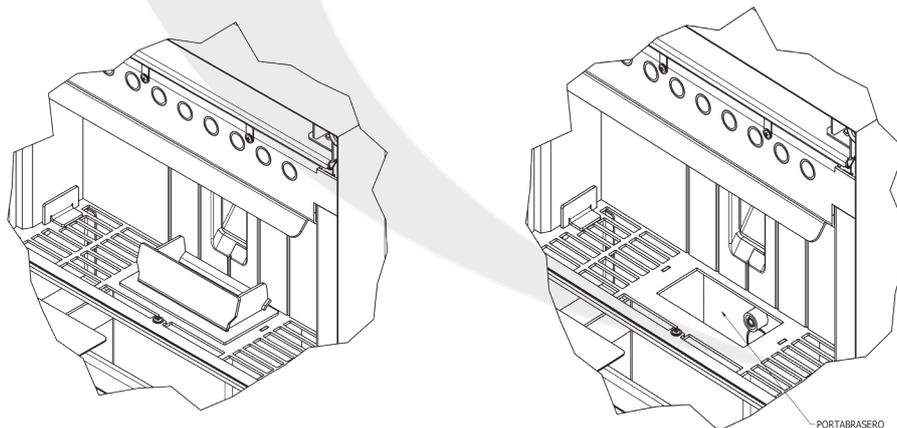
Com um aspirador de cinzas, remover a cinza acumulada dentro da câmara e dentro do porta-braseiro.
