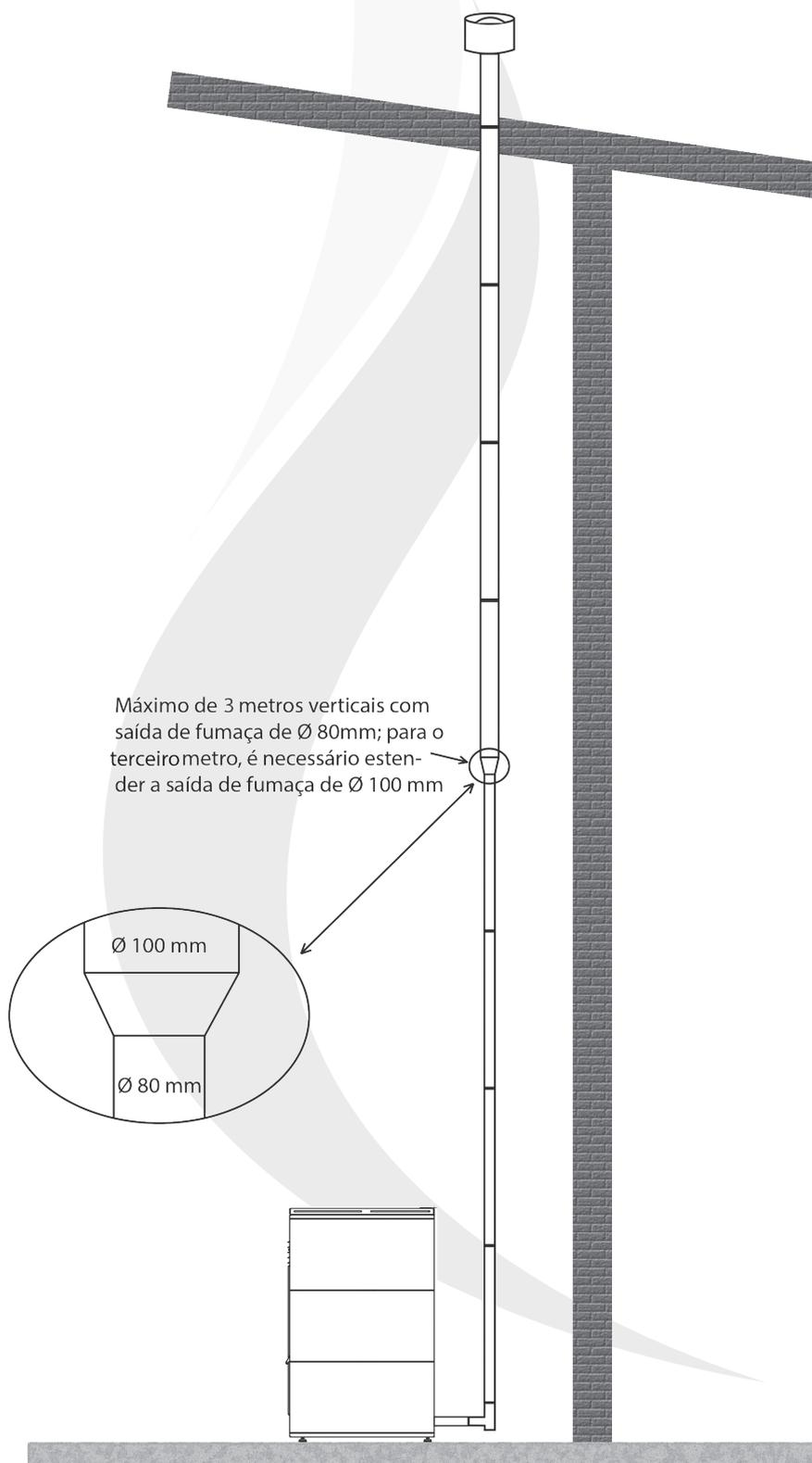
A “**perda de carga equivalente**” de uma instalação é o resultado da soma dos metros totais da instalação, mais as perdas adicionais que se derivam da seguinte tabela:
