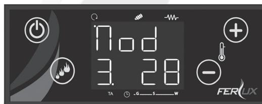
A estufa deteta que o calor gerado não pode permutá-lo por completo, pelo que entra em estado de modulação para garantir uma permutação máxima, o máximo rendimento e uma poupança de combustível.
