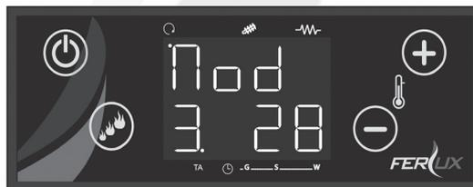
La stufa rileva che il calore generato non può scambiarlo interamente quindi va in stato di modulazione per garantire uno scambio massimo di calore, un massimo rendimento e un consumo ridotto di combustibile.
