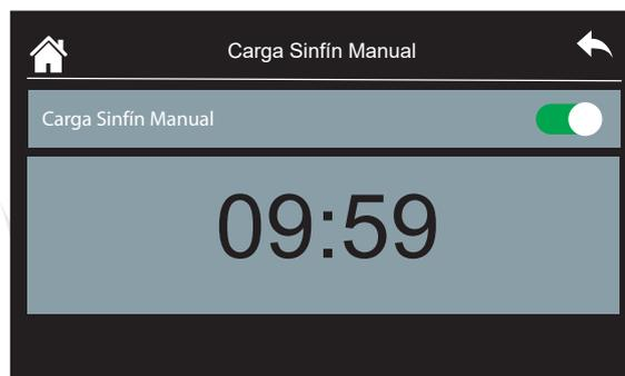
En el primer encendido de la caldera, antes de proceder a hacer el encendido, debemos hacer una carga manual del tornillo sinfín.
