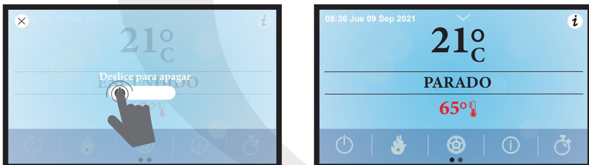
Pulsamos el botón P1 de forma prolongada, deslizamos hacia la derecha y la caldera entra en proceso de apagado hasta llegar al estado de parado.
